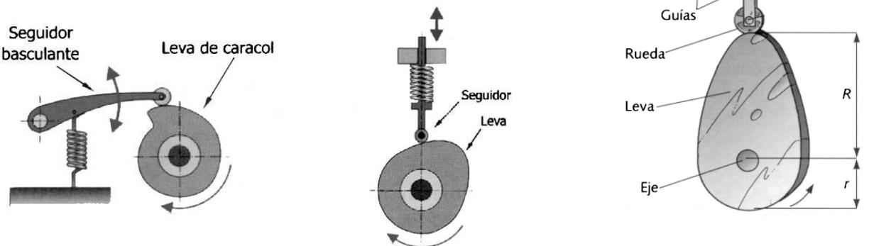
El desplazamiento del seguidor es igual a la diferencia entre el radio mayor y el radio menor de la leva ( $R - r$ ).
