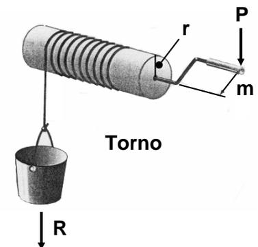
Por otra parte, cuanto más fino es el cilindro, más vueltas hay que darle a la manivela para subir la carga una determinada altura. Si llamamos NV al número de vueltas, r al radio del cilindro y H a la altura que sube la carga, se cumple:
