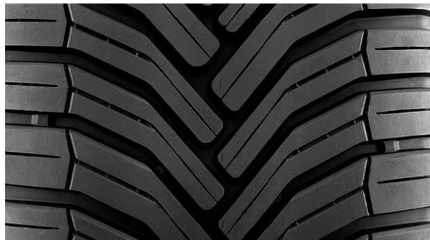
El dibujo de los neumáticos tiene la misión de evacuar el agua para que el neumático apoye directamente sobre el asfalto.
