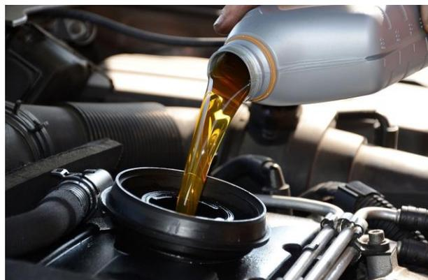
El aceite del motor tiene como misión, entre otras cosas, reducir la fricción entre las partes móviles del motor.
