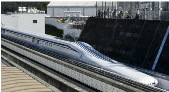
Se reduce el rozamiento a cero, ya que el tren “levita” sobre las vías. Esto hace posible que el tren alcance velocidades de 600 km/h.
